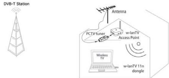
Como una alternativa a la conexión ad-hoc inalámbrica pura, puede utilizar el puerto Ethernet incorporado del w-lantv 50n Access Point para conectarse directamente a su conmutador de red local o router.
